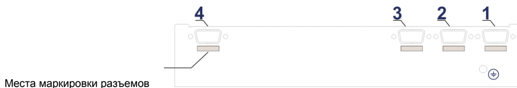
Рисунок 1.2.4 – Тыльная сторона IPC GRIDEX II в корпусе 11". Позиции 1 - 4 – разъемы DSUB-9 (DB-9).
